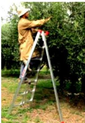
*Échelle conique correctement positionnée*
