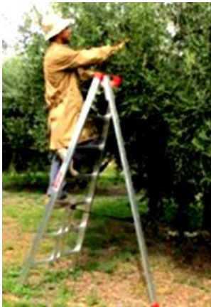
Drabina stożkowa w prawidłowej pozycji
