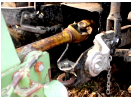
Niezabezpieczony wał Kardana
